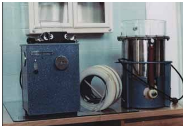
Obr. 3. Hradecká cívková ledvina: prstová pumpa, dialyzační cívkový dialyzátor a recirkulační kotlík pro dialyzátor s pumpou pro recirkulaci dialyzátu
