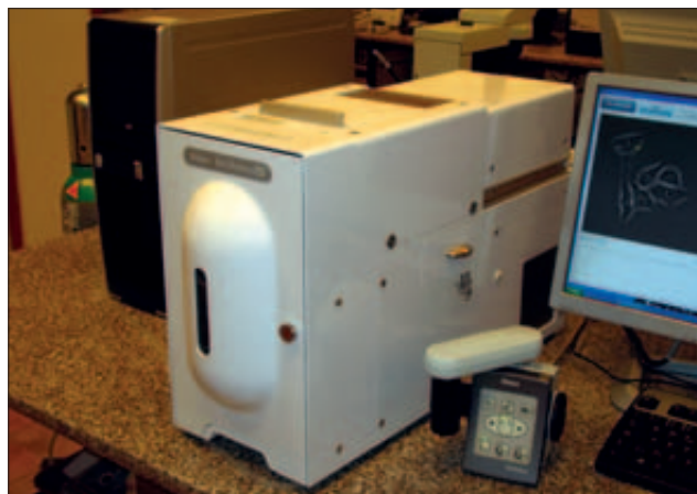
Současná podoba mikroskopu pro dlouhodobé sledování (a filmování) buněk pěstovaných in vitro
