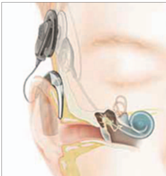
Obr. 4 – Kochleární implantát – schéma vnitřní části a řečového procesoru
