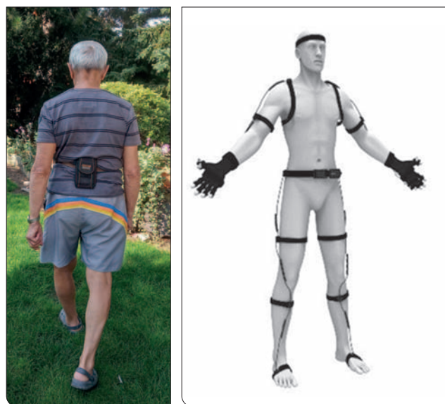
Obrázek 2: snímání parametrů chůze pomocí mobilního telefonu upevněného v pouzdře na pase a pomocí synchronizovaných pohybových čidel
