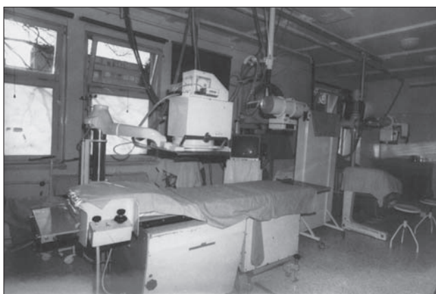
Obr. 4. Angiografický přístroj značky Elema Schönder vyrobený v roce 1963 ve Švédsku. Na tomto zařízení byly prováděny TIPSy. Sloužil až do roku 2001
