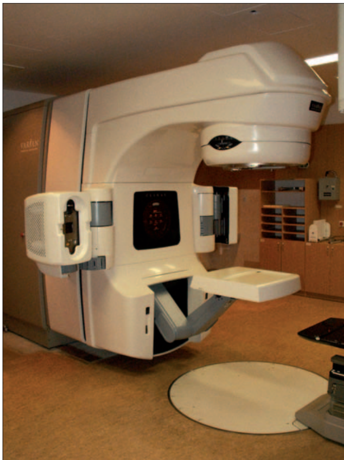
Obr. 2: Lineární urychlovač s možností radioterapie naváděné obrazem (IGRT)
